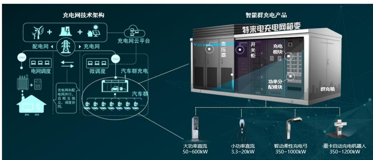
新能源微电网系统产品主要包括新能源微电网箱变、新能源光储充一体化车棚、梯次储能系统等，采用模块化设计和标准化接口，能够通过公司自主研发的微网控制器高效聚合电动汽车充电、分布式光伏发电、常规储能和梯次电池储能等资源，实现能源监控、经济优化、调度响应等多种功能。
