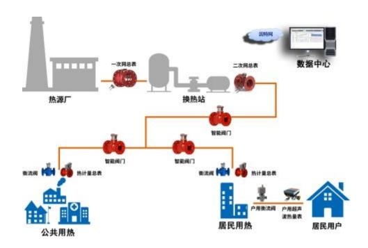
公司智能超声热表类产品包括超声热量表、智能控制阀和智能衡流阀等产品,其中超声热量表为主要产品。超声热量表采用超声波流体测量原理,通过换能器和温度传感器提供流量和温度信号,经过密度和热焓值补偿及积分计算得出热量值,进而测量及显示水流经热交换系统所释放或吸收热量。公司智能超声热表类产品主要应用于北方集中供暖市场。公司智能超声热表类产品具体情况如下:
