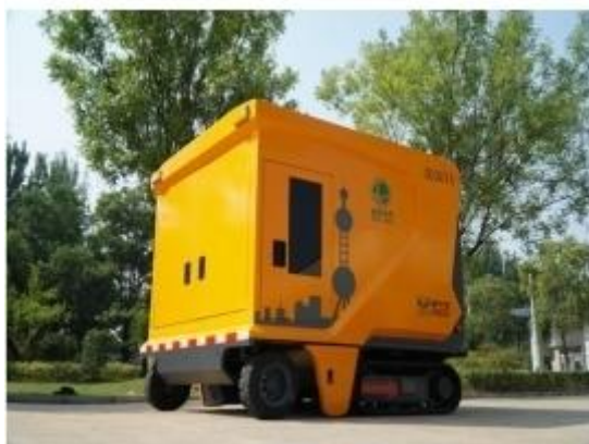
小型化履带式箱变车
