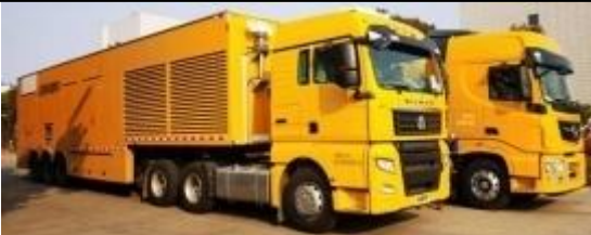
2000kW/10kV 中压电源车
