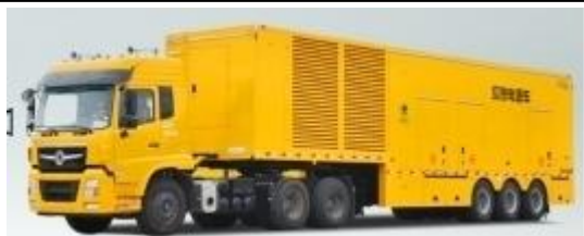
1600kW/10kV 中压电源车
