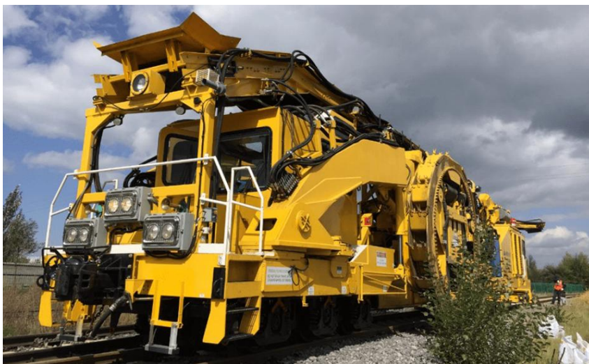
图 18 哈斯科 G04S-III-CN 型道岔清筛车
