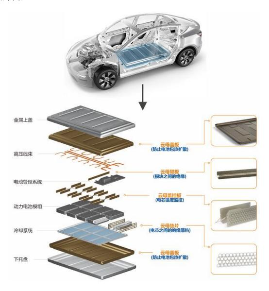
公司新能源绝缘材料产品主要包括云母盖板、云母隔板、云母监控板、云母垫片等,主要产品图示如下:
