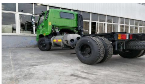
集成式侧挂车LNG供气系统（容积 160L、200L、240L、275L、330L、335L、 375L、450L、500L）
