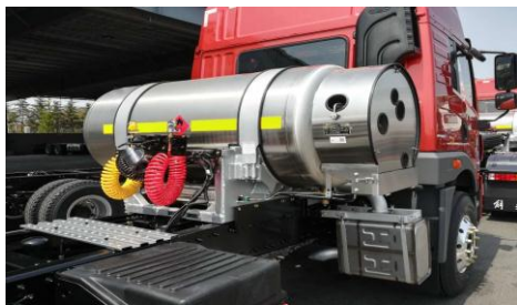
单瓶后背式车载LNG供气系统（容积 450L、500L、750L、850L、950L、995L、 1,000L、1,350L）
