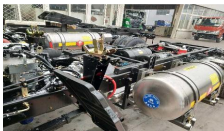
分体式侧挂车LNG供气系统（容积 160L、200L、240L、275L、330L、335L、 375L、450L、500L）
