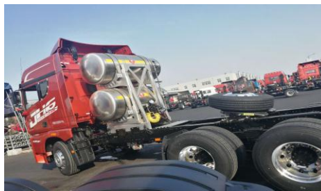
双瓶后背式车载LNG供气系统（容积 450L、500L、750L）
