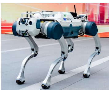
图 7 深城交巡检机器狗
