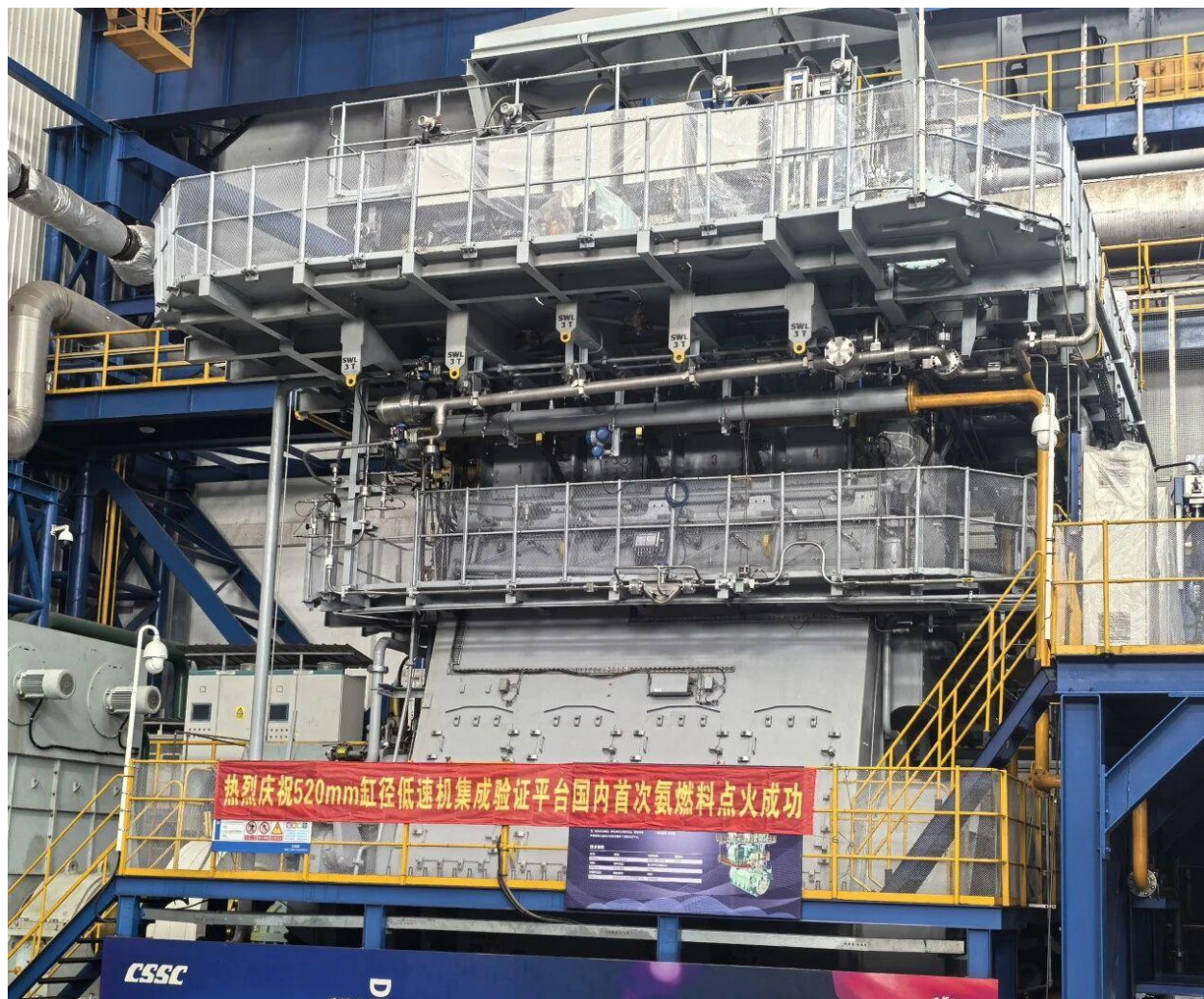
我国首台自主研发 520mm 缸径低速机技术集成验证平台，成功实现氨燃料加注、通氨密性、氨模式点火并稳定运行。
