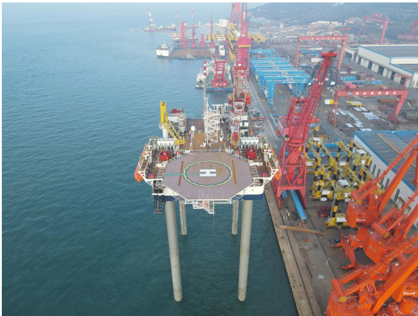
自主设计建造的 TYPE3 Pro 平台 2 号船完成关键建造节点——升降试验，为项目顺利交付奠定了坚实基础。
