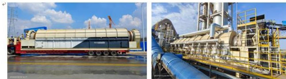
针对化工、矿山采选冶等场地污染土壤，公司结合国家重点研发计划“铈矿区铈污染源阻断及生态治理技术”，持续开展土壤增效生物淋洗、淋洗剂回收、废液净化等技术、装备工艺研究。开发的绿色高效生物淋洗剂，重金属污染土壤一级淋洗效率可达 90% 以上；通过研发的固-液-固转化工艺，可从淋洗废液中回收 50% 以上生物淋洗剂，在保障淋洗效率的同时，进一步降低药剂用量及技术成本，最大程度维持土壤微生物代谢及有机、无机碳库，保障土壤碳汇能力；废液净化后满足城镇污水排放一级 B 标准，最终实现污染土方量、污染物及污染排放的减量化。
