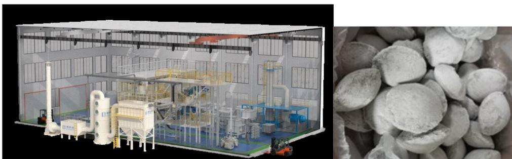
为促进新能源材料、汽车工业绿色闭环发展，探索废旧锂电池的全量化资源化综合利用新路线，公司针对废旧锂电池及电池厂废料提取镍钴锰锂有价元素回收率低、镍钴锰锂复杂溶液体系的除杂净化不彻底、沉锂回收率低以及三废全量化资源化路径不畅等技术难题，开发了“低温还原-梯度酸浸两步法资源化回收技术”体系，高效提取废旧锂电池中有价金属，采用多级萃取技术选择性回收金属，形成硫酸钴、硫酸镍、硫酸锰、硫酸铜和碳酸锂等高附加值产品，同时构建锂电池电解液氟化物的高效脱氟、沉氟和提纯系统回收氟资源、碳粉资源化、铁资源再利用技术。该技术体系用于废旧锂电池的资源化综合回收中，目前已实现镍钴回收率 99.3%以上，锂回收率 90%以上，工艺废水循环利用率 95%以上。目前已完成小试、高价金属回收提纯的中试试验研究，固废及尾气、废水的资源化正在进行试验研究，回收利用技术正在进行产业化推广应用。
