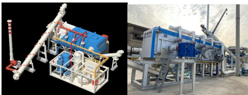
针对化工、矿山采选冶等场地污染土壤，公司结合国家重点研发计划“铋矿区铋污染源阻断及生态治理技术”，持续开展土壤增效生物淋洗、淋洗剂回收、废液净化等技术、装备工艺研究。开发的绿色高效生物淋洗剂，重金属污染土壤一级淋洗效率可达 90% 以上；通过研发的固-固转化工艺，可从淋洗废液中回收 50% 以上生物淋洗剂，在保障淋洗效率的同时，进一步降低药剂用量及技术成本，最大程度维持土壤微生物代谢及有机、无机碳库，保障土壤碳汇能力；废液净化后满足城镇污水排放一级 B 标准，最终实现污染土方量、污染物及污染排放的减量化。
