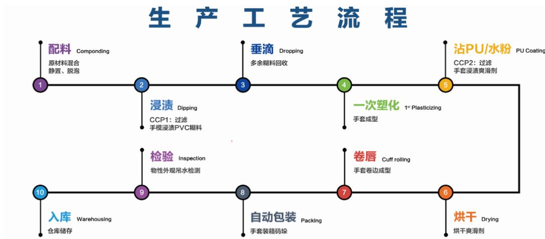
PVC 手套生产的主要工艺流程为：手模浸渍 PVC 糊料经垂滴后进行塑化，降温冷却后浸渍 PU 或水性玉米淀粉，干燥后进行卷唇，经预脱、自动脱模机后，分拣出缺陷品后进行码查包装。之后用毛巾等擦拭手模余料，干净的手模再次浸渍 PVC 糊料进行循环生产。
