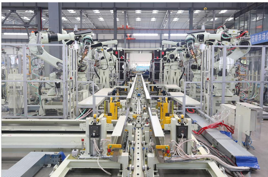
图：公司为新能源汽车车身及电池提供的智能柔性自动化生产线
