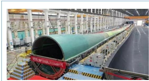
2021年9月，恒神股份以自产碳纤维生产的拉挤碳板成功在国内首支百米级大型海上风电叶片上应用。
