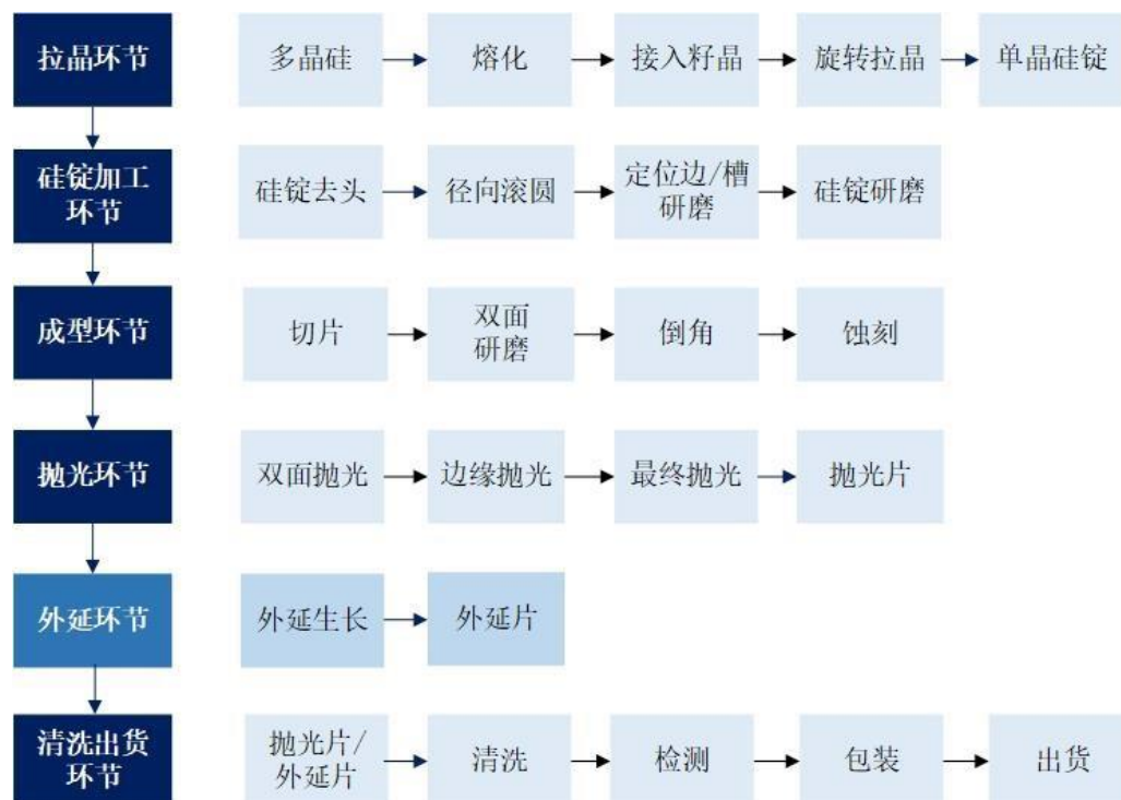
图 5-5 半导体抛光片、外延片工艺流程图
