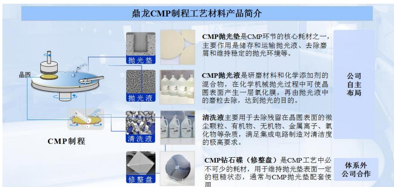
图 3.2.1：鼎龙 CMP 制程工艺材料产品简介
