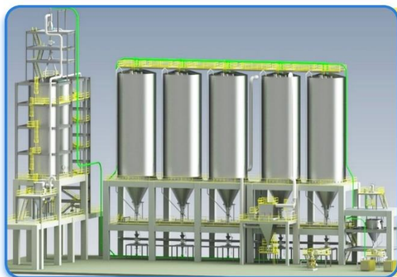
粒料输送系统示意图
