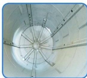
掺混料仓内部贴壁掺混管
