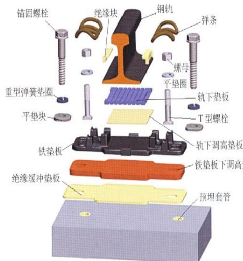
WJ-7型扣件组装零件图
