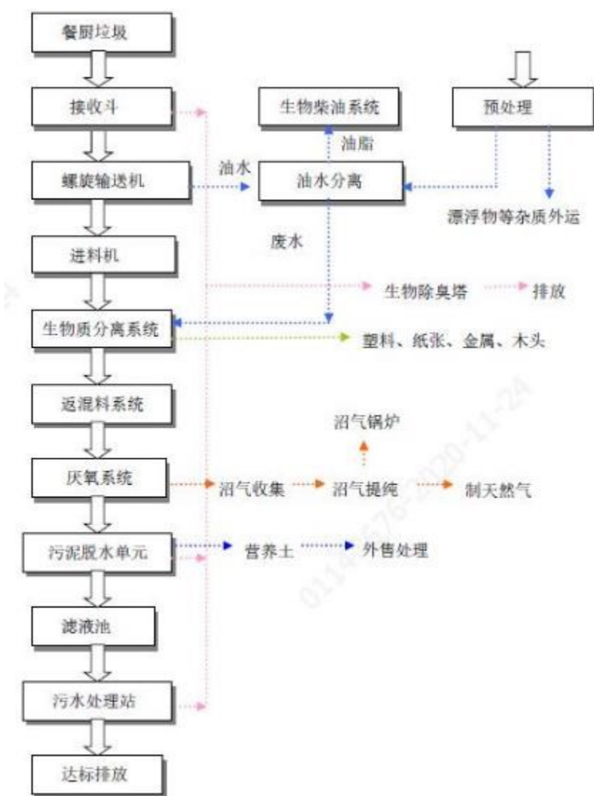
图：餐厨垃圾处理工艺流程
