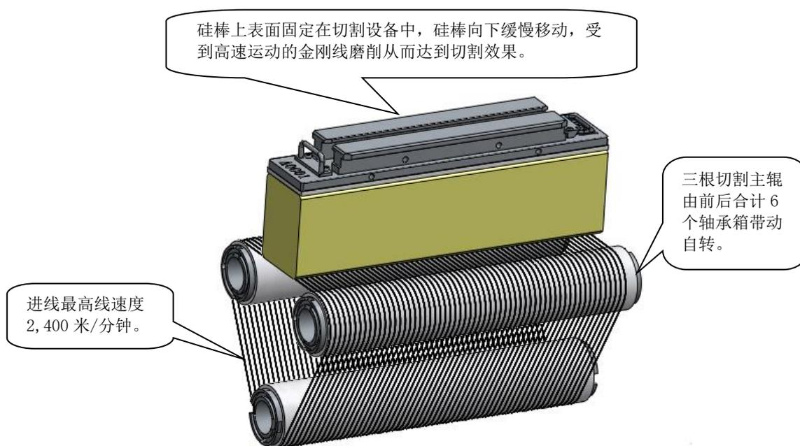
目前应用于切割光伏硅片的金刚线的母线直径在 $30\text{-}34\mu\text{m}$ 之间，母线直径比人体头发丝（ $80\text{-}90\mu\text{m}$ ）还要细；硅片半片厚度最薄可至 $60\mu\text{m}$ （A4纸的厚度约为 $104\mu\text{m}$ ）；另外，硅片有多个严苛的表面质量指标。
