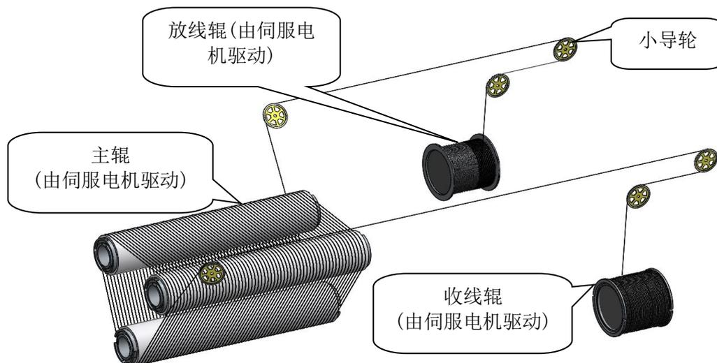
切片机切割硅片的第一步工作是金刚线布线，即：切片机的自动排线系统首先将一根长度200km以上、直径30 $\mu\text{m}$ 及以上的金钢线（人体头发丝直径80-90 $\mu\text{m}$ ）由放线辊放出进入切割区域，均匀、精密地反复缠绕在切割区域内的3根主辊上，主辊上有细密的绕线凹槽，单根金刚线排布在凹槽内，并排布置成约由近4,700根、间距低于205 $\mu\text{m}$ 的金钢线线网，然后再被收线轮从切割区域引出。由于金刚线直径和线网密集程度均为微米级，切片机金刚线管理系统需要精准排线，收放线轮、小导轮、主辊均需要同步精准运转，否则容易导致切割过程中金刚线断线，进而可能造成比较严重的硅料损失。
