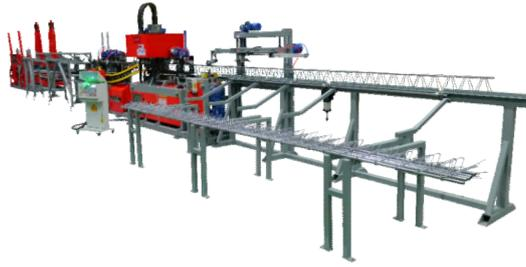
(2) 数字化增效赋能装配式建筑生产企业：钢筋桁架楼承板智能集成生产线
