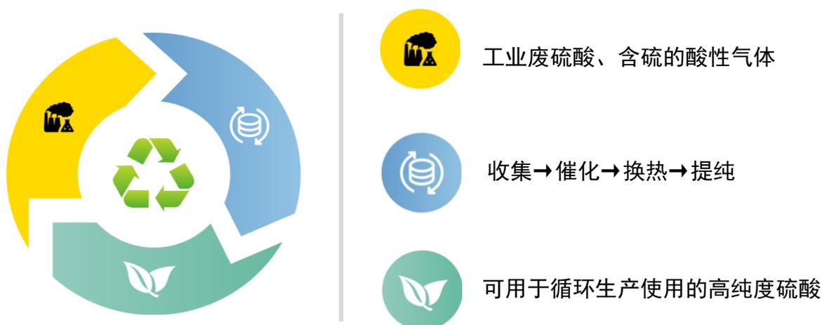
博奥环境目前主要从事设计、生产、销售以工业废酸再生工艺及装备为代表的节能减排环保工艺装备。工业废酸再生工艺及装备通过对客户化工生产中的工业废硫酸、含硫的酸性气体进行收集、处理，生成高纯度硫酸用于循环生产，并释放热能用于回收再利用，实现节能、减排、循环利用、经济、环保的效果，助力实现碳达峰和碳中和减排目标
