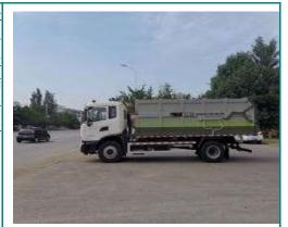
车厢可卸式垃圾车 该系列产品通过高强度勾臂与可卸式垃圾箱配 套使用;箱体有后门液压自动锁紧装置,防污水 渗漏装置和,密封性好,确保垃圾运输过程无 洒漏; 驾驶室内能实现箱体后门自动启闭和锁 紧。用于定点垃圾的收集和运输。
