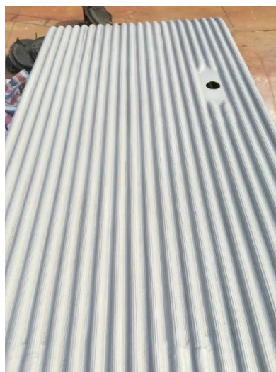
图2 HCMT冷焊加工后的管排
