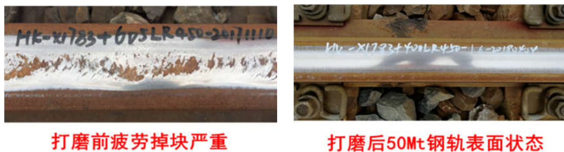
图 4：钢轨打磨前后状态对比
