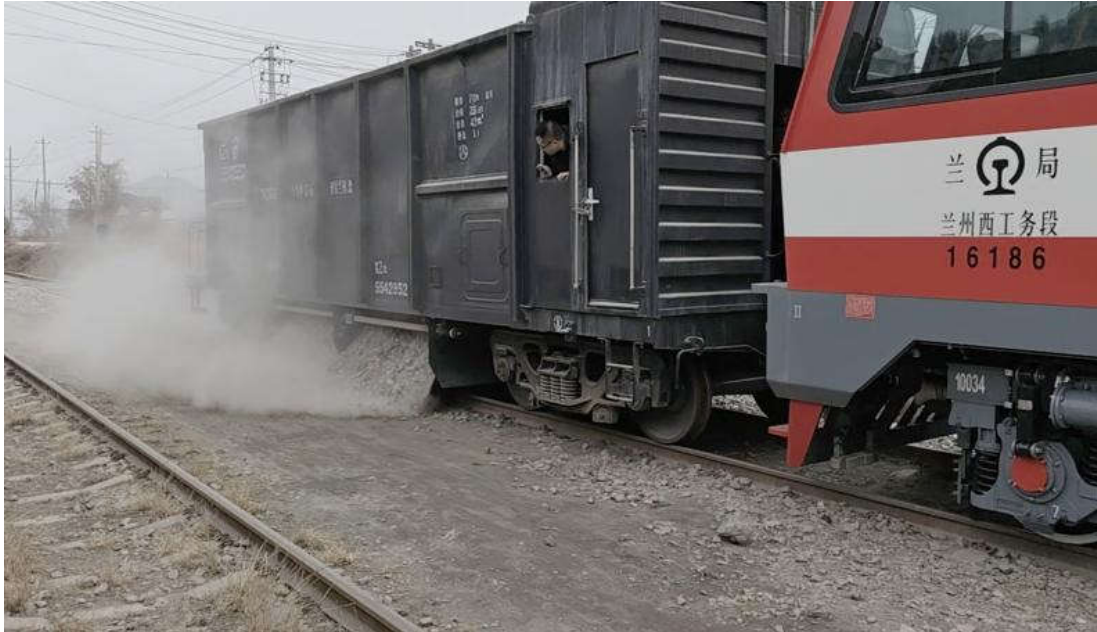
图 11：石砟漏斗车智能卸料系统
