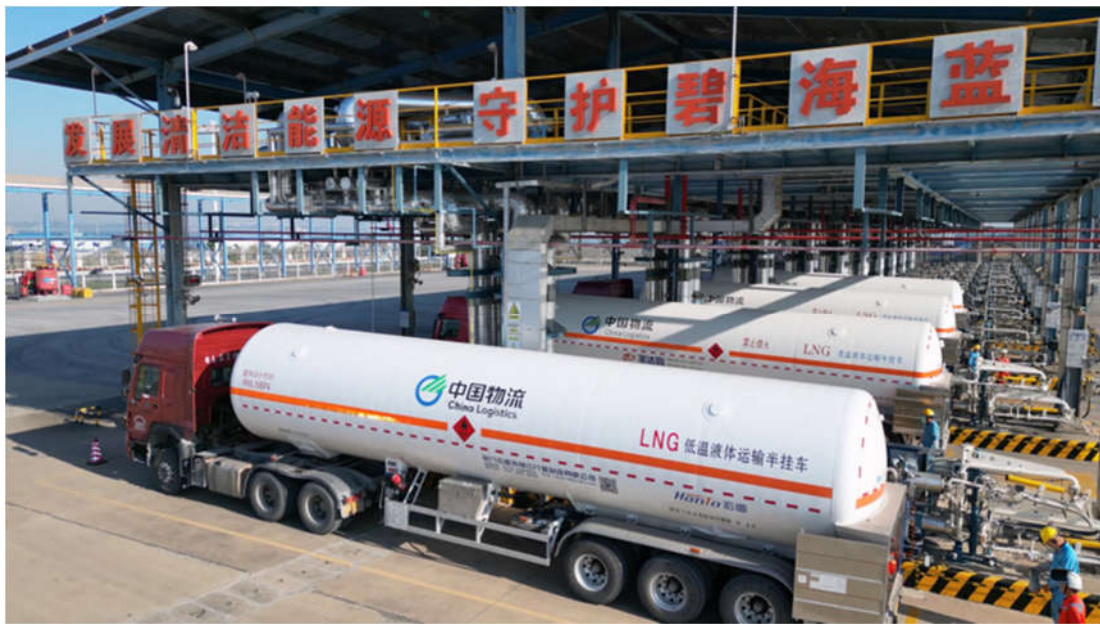
图 15: 公司在广西北海接收站进行 LNG 装配作业
