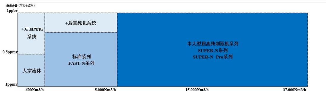
对于小规模或爬坡阶段的供气需求，公司与外资气体公司均开发了标准系列制氮装置。公司自主研发的“Fast-N”系列制氮装置，通过后置纯化系统，实现最终产品杂质含量控制在 1ppbv 以内的目标，并通过撬装模块化设计，具备占地面积小、能耗低、交付时间短等特点。
