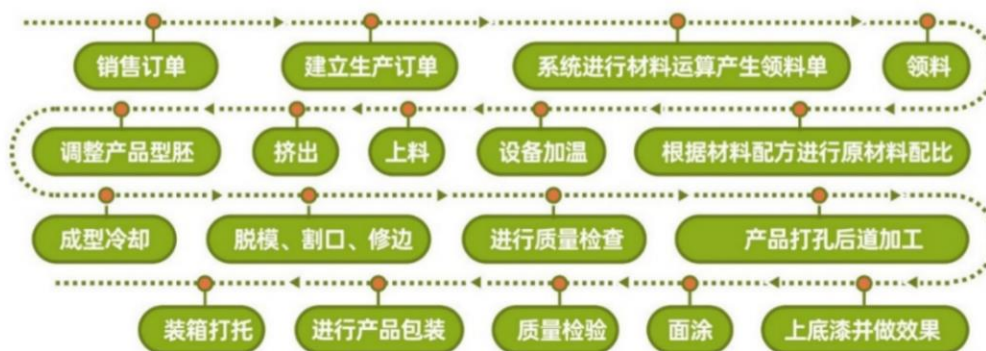
塑料盆器生产流程图
