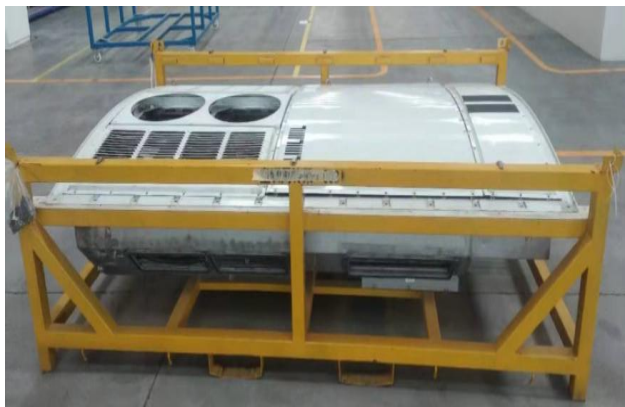
图 3-13 CRH1 平台动车组空调检修产品
