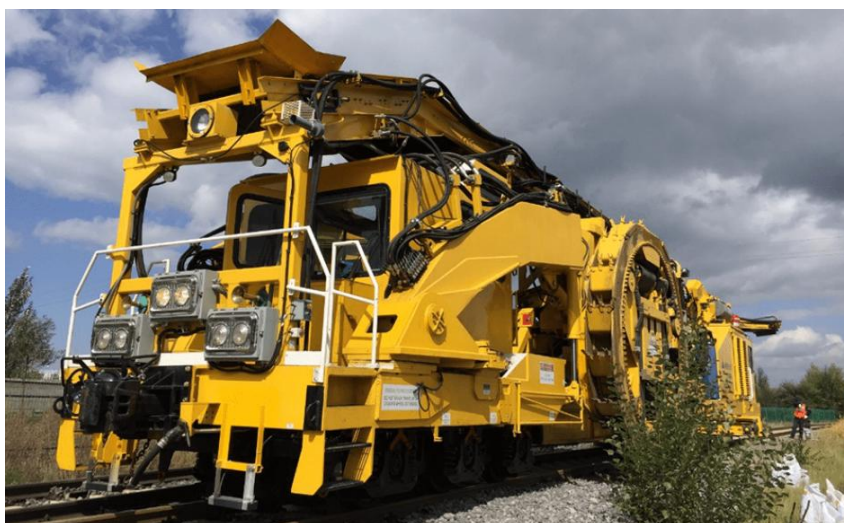
图 3-17 哈斯科 G04S-III-CN 型道岔清筛车
