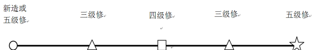
图 3-11 动车组高级检修周期循环图
