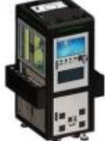
云台检测设备    | 对于各类手机中框，手表框，平板框外观不良的检测；云台检测设备可单机使用，也可以 2 台或者多台联机使用；可以前后对接上下料机，实现全自动上下料检测；设备采用模块化设计，可以根据产品工艺和要求进行自由拼接。 |
