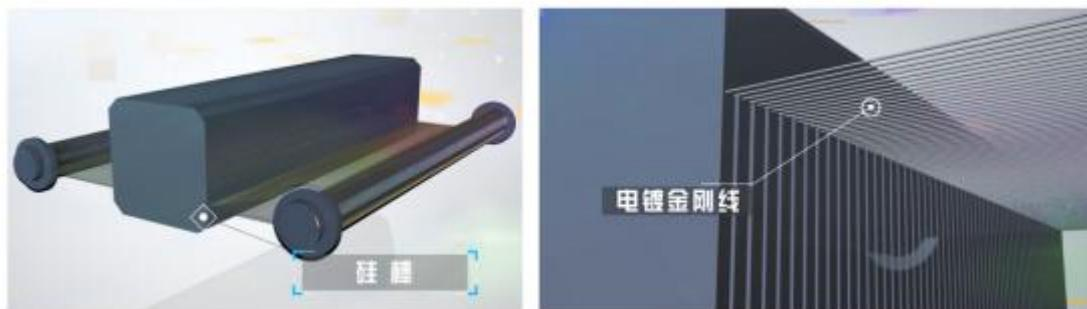
公司电镀金刚石线产品目前广泛用于单晶硅和多晶硅切片，可适配各种型号的硅片切割专用机和改造机，并可根据客户机型和切割工艺的需要定制各种类型的金刚石线产品。
