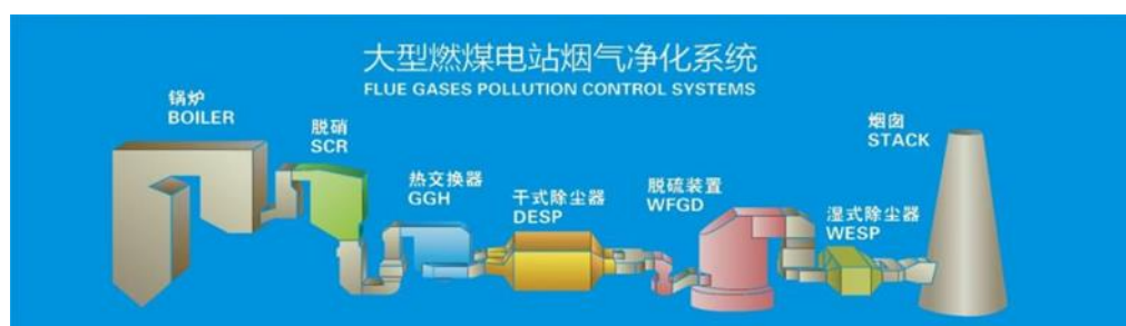
图5-11：燃煤电站炉后烟气环保岛大成套系统图
