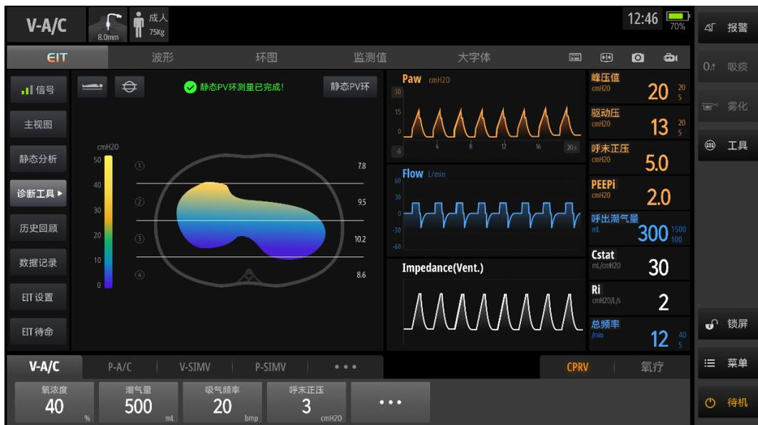
④ 通气策略评估功能。该技术发挥迈瑞“瑞智联”生态优势，通过呼吸机、监护仪、检验等病人多维度的病理和生理参数进行智能辅助决策，辅助医护人员判断机械通气病人脱机成功率；解决目前临床上，特别是基层医院在脱机时机判断上的痛点，避免提前脱机导致的病人重插管或者延迟脱机导致的病人膈肌功能障碍以及医疗资源的浪费。
