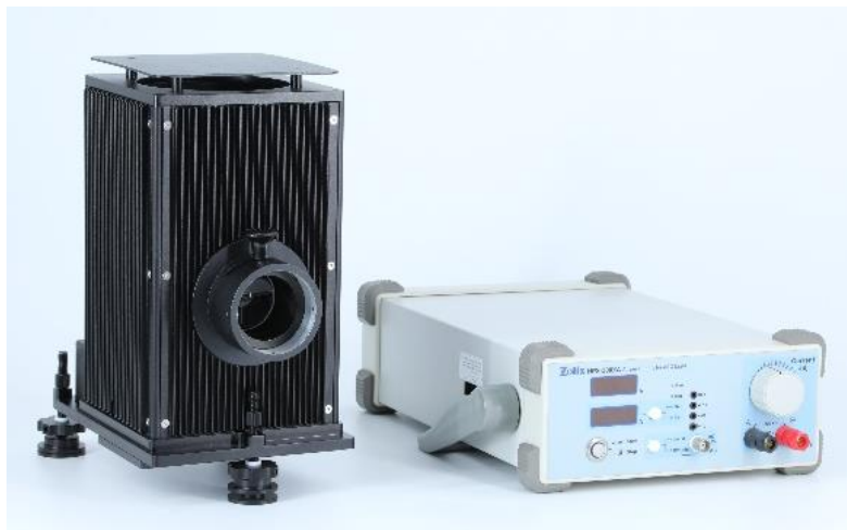
图. 典型光源系统（非激光器类光源）
