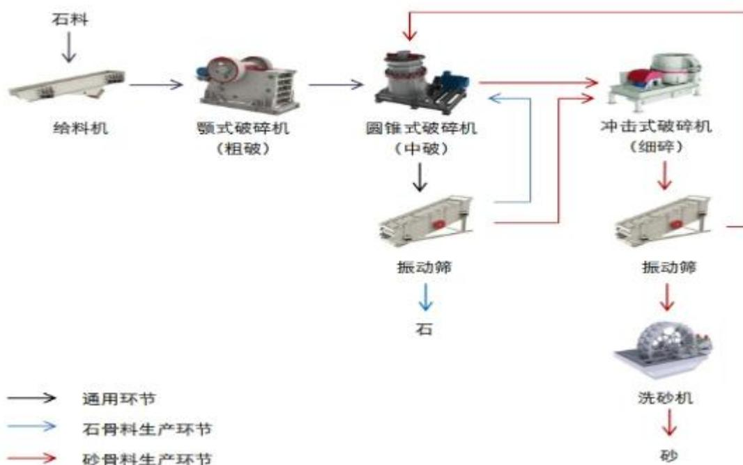
如上图所示，物料由振动给料机均匀地送到一级破碎机（主要是颚式破碎机）进行粗破，粗破后的物料由输送机送至下一级破碎设备（主要是圆锥式破碎机、冲击式破碎机）进行细破，再由振动筛进行筛分，达到成品颗粒要求的物料经过洗选程序后由成品输送带输出即为成品；未达到成品颗粒要求的物料从振动筛返回细破程序重新加工，形成闭环环节多次循环，直至达到物料成品标准。
