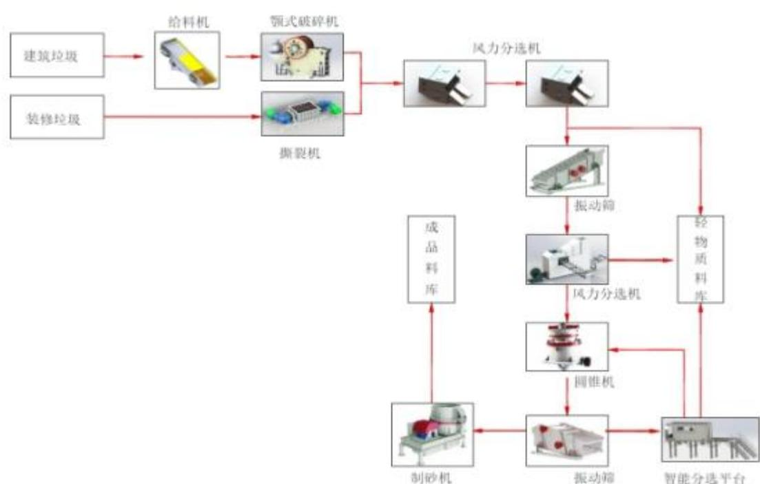
如上图所示，建筑垃圾及装修垃圾分别由颞式破碎机和撕裂机进行粗破，粗破后的物料由输送机送至风力分选机进行重轻物质的初次分离后再由振动筛进行筛选；未达到成品颗粒要求及伴有部分轻物质的物料由风力分选机进行重轻物质的二次分离；二次分离后的物料由圆锥机进行二次破碎后经振动筛筛选，再由智能分选平台进行重轻物质的三次分离；重物质最终经制砂机加工后达到成品标准。该套建筑垃圾资源回收利用设备利用多级风力分选及智能分选平台，通过在不同环节的多次重轻物质分离，保证了可燃物和不可燃物的分离率及全程无人化筛选，并确保了重物质的循环闭路加工。
