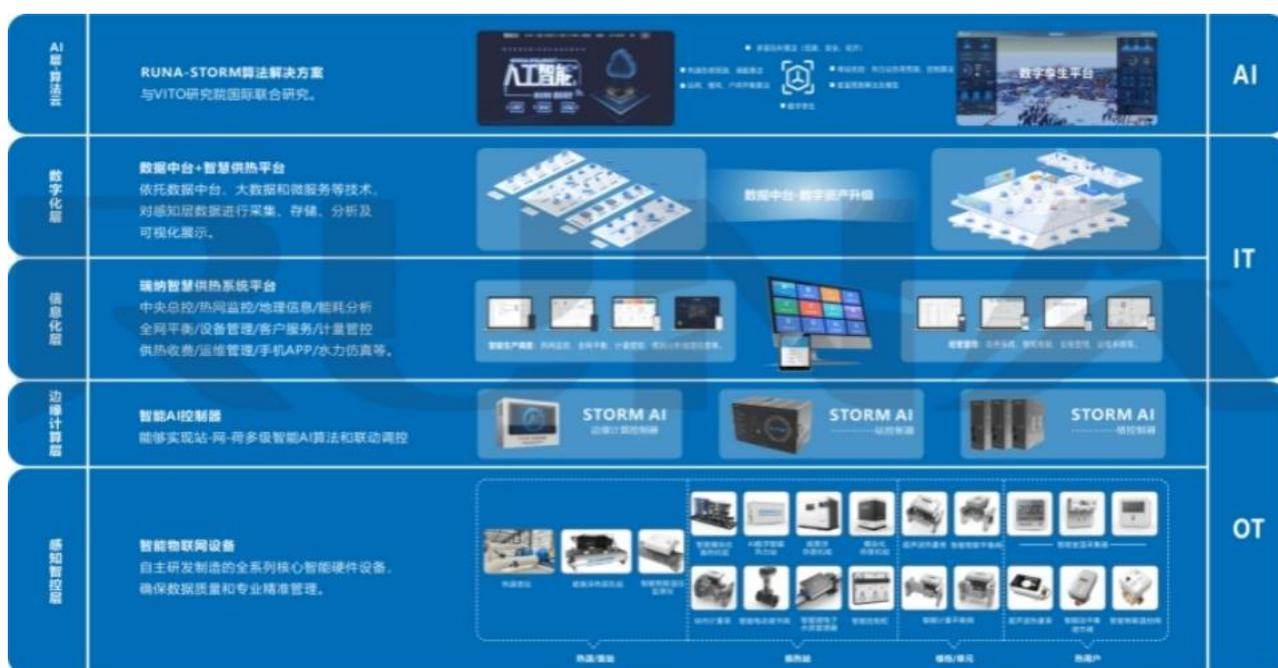
公司自主研发生产的能源智能控制设备主要包括模块化换热机组、高效智能磁悬浮热泵机组、高效智能模块化热泵机组、AI 数字智能热力站、智能控制柜、智能平衡阀、STORM AI 控制器等，主要用于供热系统管网自动化用热控制、温度调控。公司模块化换热机组与智能控制柜等配套产品可组合成智能模块化换热机组；公司智能平衡阀与楼栋超声波热量表等产品可组合成智能水力平衡装置。
