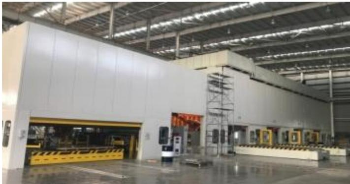
大型液压机冲压生产线
