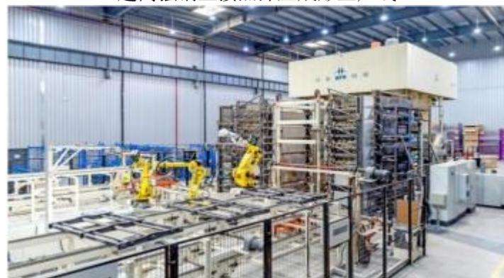
超高强钢间接热冲压成形生产线
