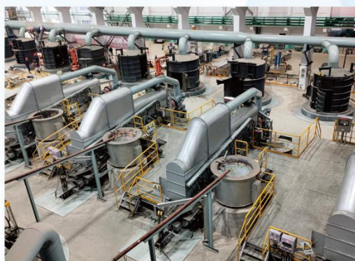
锡冶炼电热连续机械结晶机
