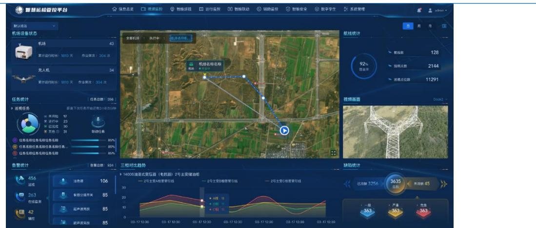
**无人机智能巡检系统:** 无人机自主巡检平台支持输、变、配巡检一体化管理，包括杆塔台账管理、巡检计划与任务管理、飞行监控、航线管理、任务调度、缺陷分析、缺陷对接上报等功能，实现无人机电力巡检业务流程闭环管理。
