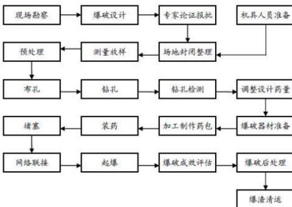
图表 5.30 拆除爆破工程流程图
