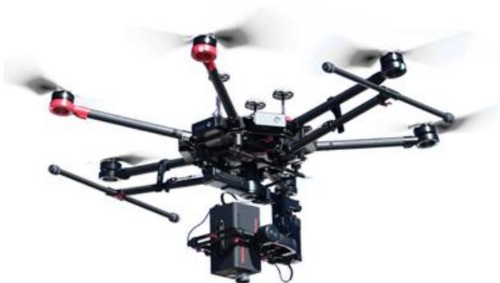
图. 典型的无人机高光谱成像检测系统
