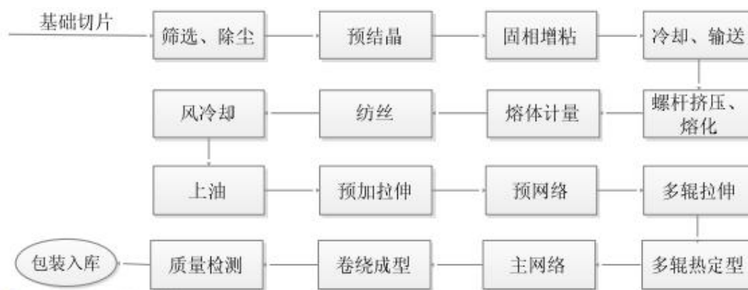
图 5-8 涤纶工业长丝生产工艺流程图
