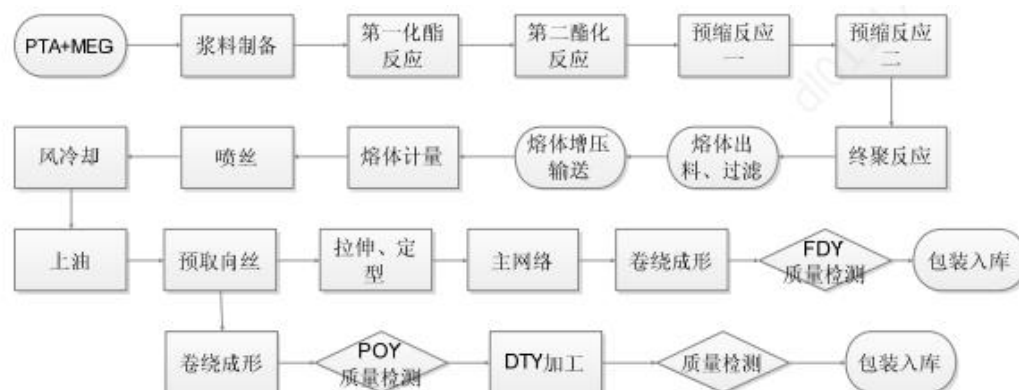
图 5-6 涤纶民用长丝整体的工艺流程
