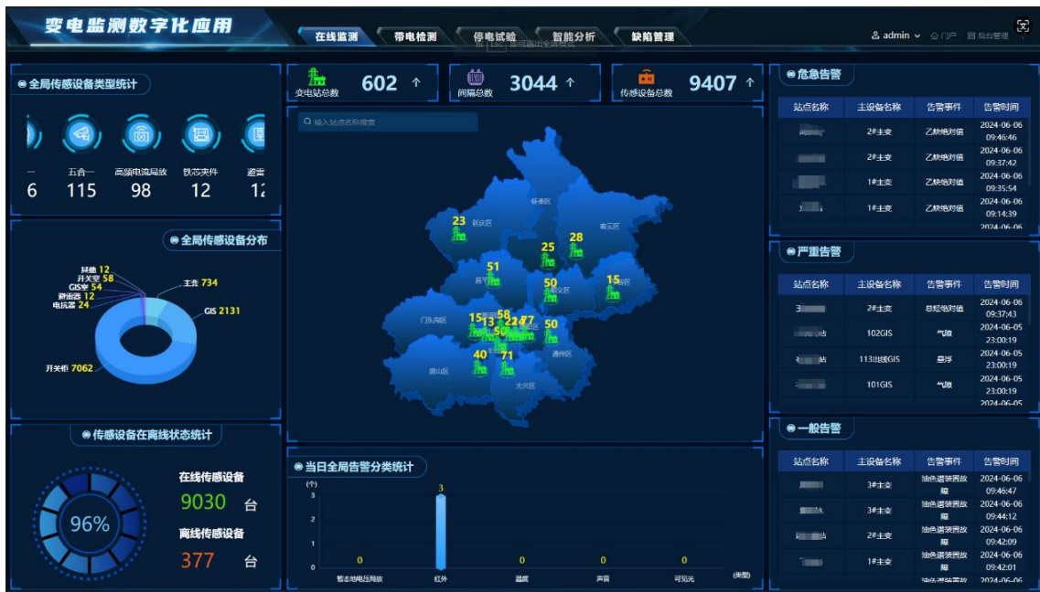
泰岳天成变电状态监测系统示意图
