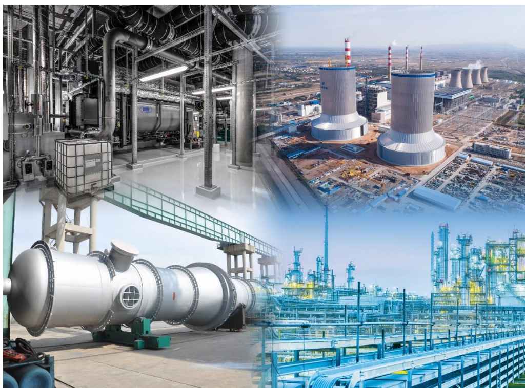
图 1：顺时针方向依次为公司溴化锂制冷机组、全钢结构间接空冷系统、工业余热利用系统以及高效换热器
