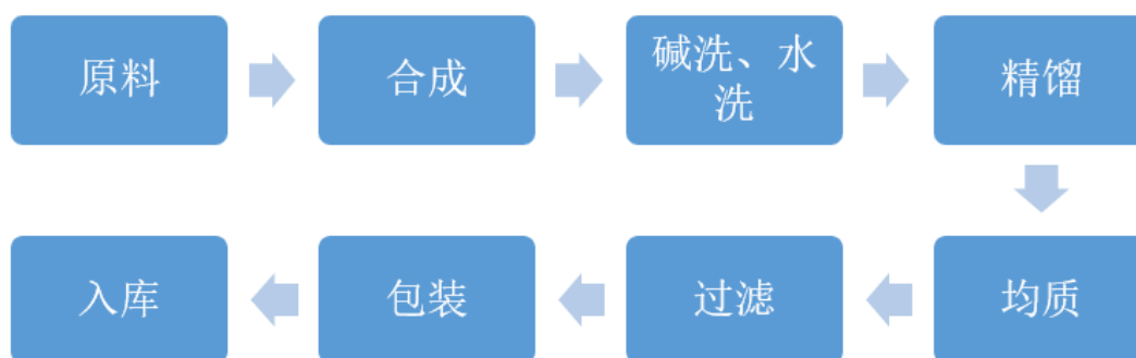
(3) 粉末香料的工艺流程图
